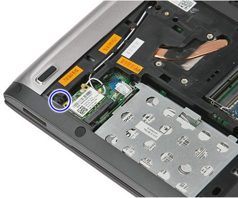
6. Extraiga la tarjeta WLAN del equipo.
