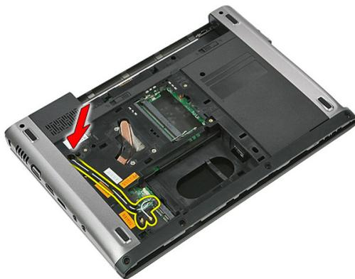
11. Saque los cables de la antena de la canaleta.
