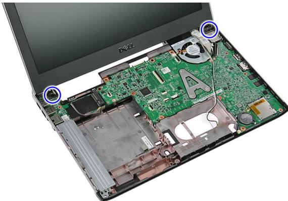
15. Levante el ensamblaje de la pantalla hacia arriba y luego hacia adelante para retirarlo.
