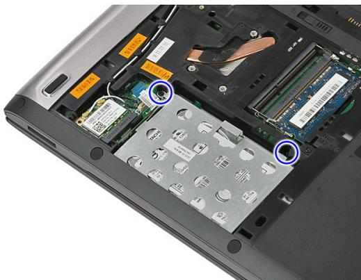
7. Levante la unidad de disco duro a un ángulo del sistema y retírela del equipo.
