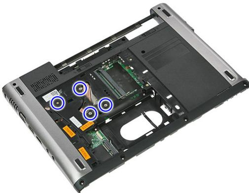
14. Desconecte el cable del ventilador que fija el disipador de calor a la placa base.
