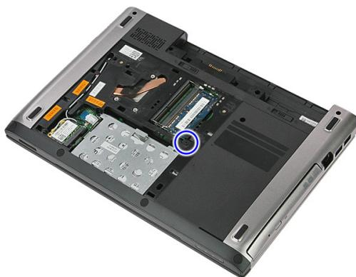
5. Con la ayuda de un destornillador, desprenda la unidad óptica del equipo.
