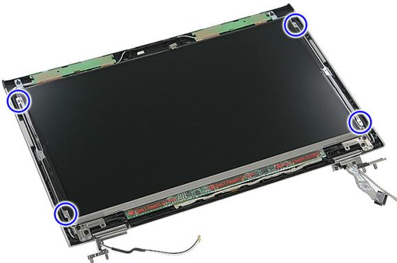
13. Levante el panel de la pantalla del ensamblaje.
