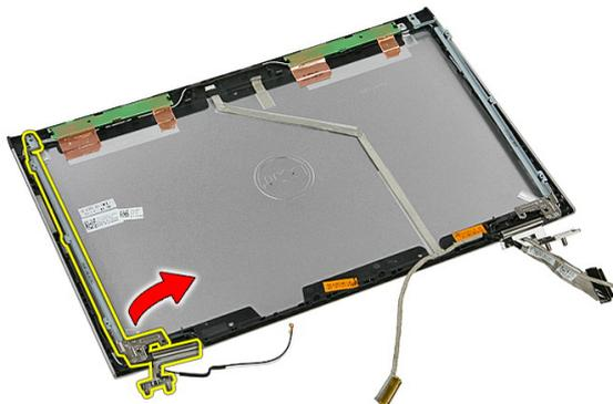
**15.** Libere los cables de la bisagra izquierda, luego retire el soporte y la bisagra izquierda.
