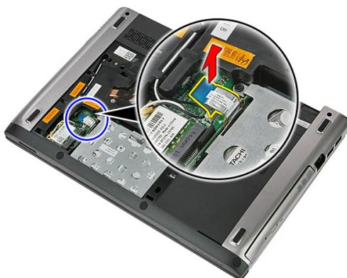
5. Desconecte el cable de la unidad de disco duro.
